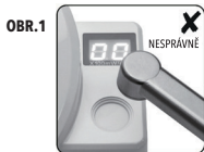
Světelná koncovka příliš daleko. Jednotka zobrazí nízké nebo žádné výsledky.
