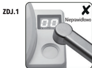
Światłowod zbyt daleko. Pomiar niski lub brak pomiaru.
