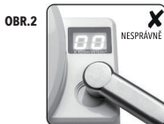
Světelná koncovka nespočívá naplocho u světlého snímače. Jednotka zobrazí nesprávné výsledky.
