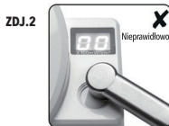
Światłowod nie dotyka płasko miernika. Pomiar niepoprawny.
