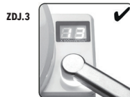
Światłowod leży płasko, dopasowany dokładnie do sensora miernika światła. Pomiar poprawny.
