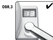
Světelná koncovka spočívá naplocho přímo na světlém snímači. Jednotka zobrazí správné výsledky.
