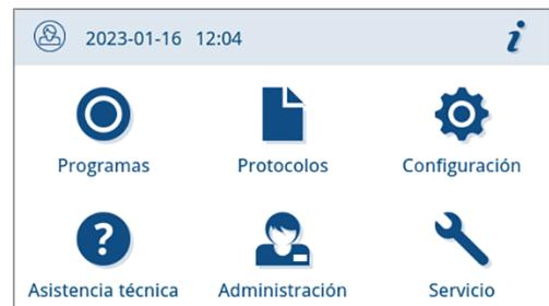
2. Seleccione los tipos de protocolo para ver o exportar uno o varios protocolos de un tipo. Para exportar todos los protocolos del programa, fallos y estado guardados en el dispositivo, utilice la función **Exportar todo** del menú de protocolos.
