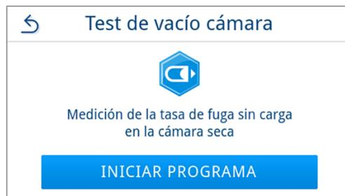
4. Espere a que finalice el test de vacío. Durante el test de vacío se indica la presión de evacuación, la temperatura y una previsión de cuándo terminará el test de vacío.
