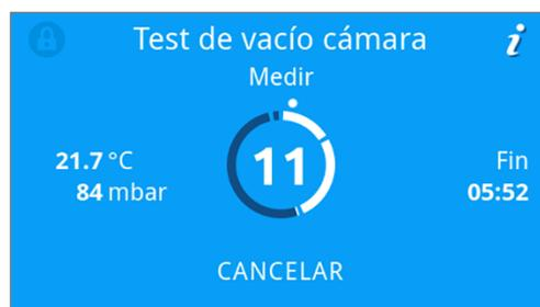
5. Una vez transcurrido el tiempo de medición, se ventila la cámara de esterilización. Luego, la pantalla muestra el mensaje que indica la tasa de fuga. Cuando el programa finaliza correctamente, el LED de estado del equipo (LED izquierdo) se ilumina en verde y suena una señal acústica una vez.
