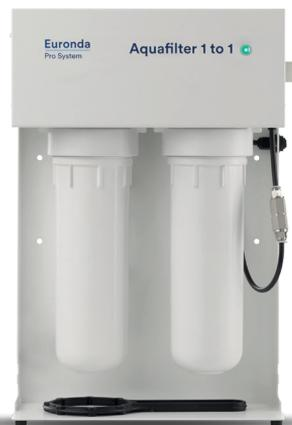
Dispositivo para producir agua desionizada para autoclaves, conforme a la norma EN 13060 (<math>< 15 \mu\text{S}/\text{cm}</math>). Permite suministrar agua a un solo autoclave Euronda Pro System. Desioniza una media de 1 litro de agua por minuto. Se puede equipar con un dispositivo de desconexión automática. Puede colocarse directamente en la superficie de trabajo, dentro del armario o fijado en la pared. El suministro inicial incluye 2 resinas de intercambio iónico.
