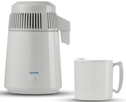
Destilador de agua que permite obtener agua destilada por ebullición y la posterior condensación del vapor. Destila 0,7 litros de agua cada hora. Capacidad de 4 litros. Cumple con las pruebas de seguridad y compatibilidad electromagnética (2014/30/UE) y baja tensión (2014/35/UE).
