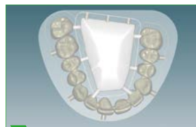
3 Lengua de sinterización (estabilizador) antes de la esqueletización
