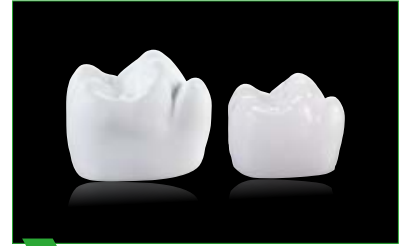
3 Molar antes y después de la sinterización; contracción de sinterización del 20 por ciento, aprox.
