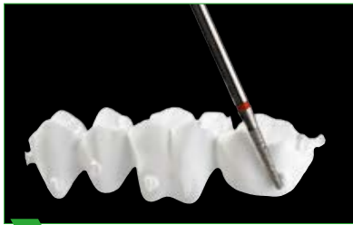
4 Desbastado de los conectores con fresa de diamantes o de carburo de tungsteno.
