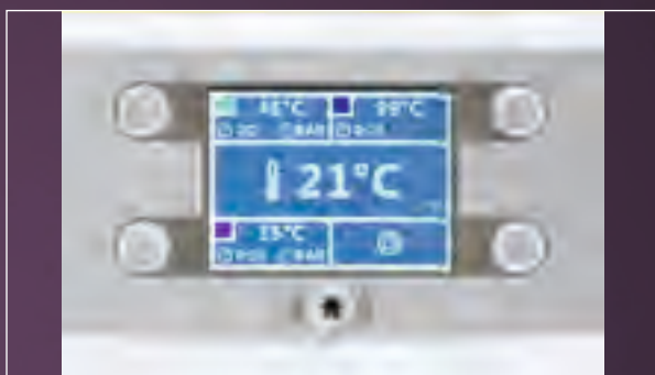
Los botones funcionan con las manos o los guantes mojados (a diferencia de las pantallas táctiles)
